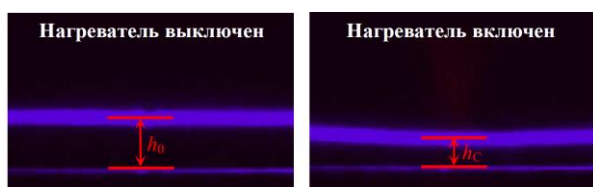
Рис. 2. Термокапиллярная деформация силиконового масла ПМС-5 (толщина недеформированного слоя h_0 = 228 мкм).
