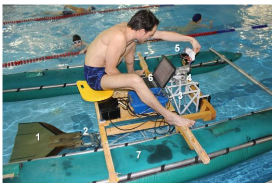
Рис. 1. Экспериментальная установка по исследованию характеристик подводного машущего крыла: 1- ласт, 2- датчики, 3- подвижно-суставный механизм, 4-червячный редуктор 5-электродвигатель с контроллером, 6 система сбора данных, 7-подвижная платформа.
