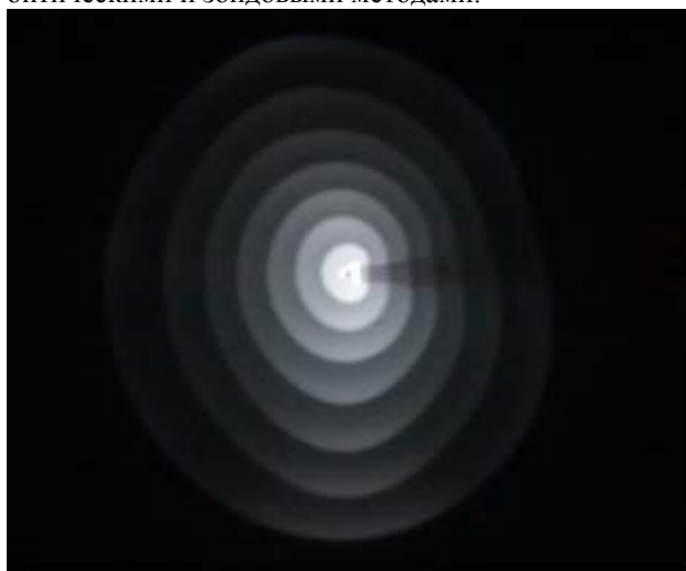
Рис. 1. Сферическая стратификация газового разряда в этиловом спирте при давлении 13 Па. Радиус внешней страты 15 см, ток разряда 30 мА.
