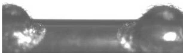
Рис. 3. Фрагмент распространения фронта испарения в недогретой жидкости. Толщина теплового слоя до температуры насыщения 38 мкм, полная толщина теплового слоя 120 мкм. Экспозиция 8 мкс; \Delta T_s = 46 К; P = 0.353 МПа.
